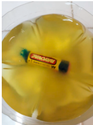
Figura 3 - Pilha mergulhada na solução salina gelatinosa, 24 horas depois da imersão da pilha
