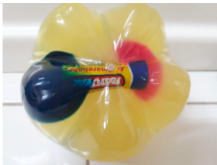
Figura 3 - Pilha mergulhada na solução salina gelatinosa, 24 horas depois da imersão da pilha
