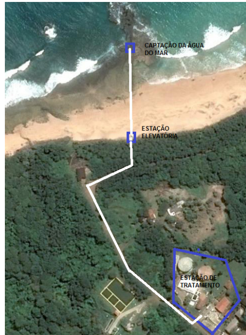
Figura 41 – Captação e Estação Elevatória
