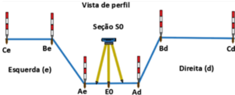
Figura 110 – Marcação dos pontos onde há mudança de conformidade do relevo.
