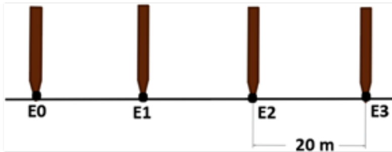
Figura 103 – Estaqueamento de 20 m.
