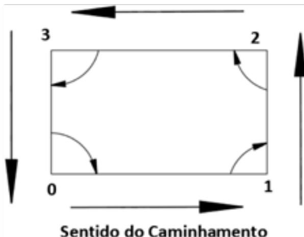
Figura 56 – Sentido anti-horário do caminhamento numa poligonal fechada e leitura dos ângulos internos no sentido horário.
