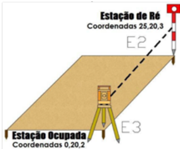
Figura 27 – Segunda estação em diante com o uso da estação total pelo método de levantamento por coordenadas.
