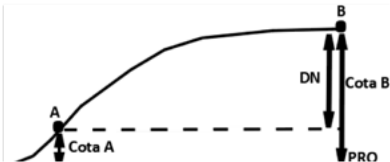
Figura 88 – Método para obtenção das diferenças de nível através do nível de mangueira.
